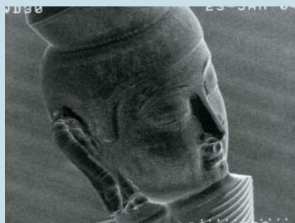
弥勒菩薩 頭部 Micro Buddha-head 直径 [Diameter]: 1mm, 高さ [Height]: 1.5mm
