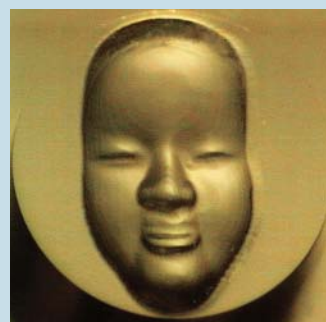
能面 Micro Noh-mask 直径 [Diameter]: 1mm, 高さ [Height]: 30 μm 材質 [Material]: 18金 [18gold]
